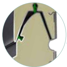
joints d'étanchéité entre les panneaux
